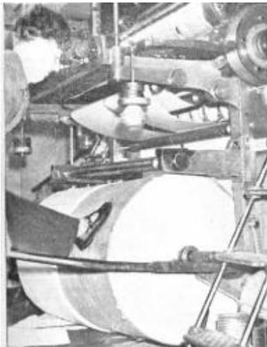
8 Uhr: Die ersten großen Papiertrommeln werden der Rotationsmaschine zugeführt. Das Ostpreußenblatt wird gedruckt. Zwanzig solcher Rollen gehören zu einer Ausgabe, und jede wiegt 360 Kilogramm. Mehr als sieben Tonnen Papier also müssen in wenigen Stunden bedruckt werden.
